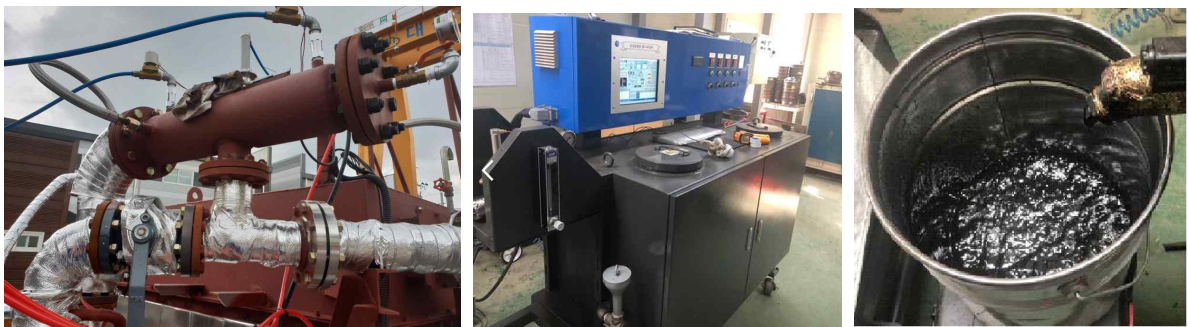
그림 1. 한국형 기포 아스팔트 발생 설비(파일럿 버전)
