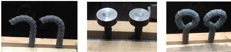
그림 1. PCRPC 접속부 철근 형상
